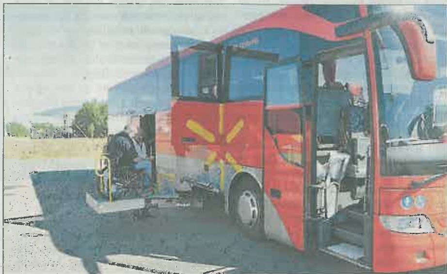
■ Un système d'élévateur permet aux personnes en fauteuil roulant d'accéder au bus.
